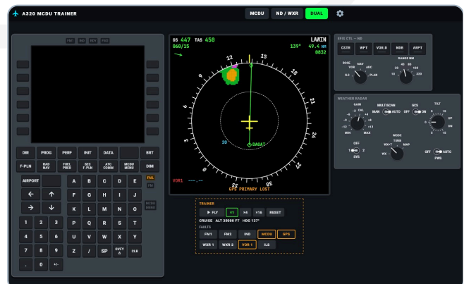
MCDU FAIL and VOR 1 fault (ROSE VOR).
